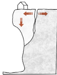
Rupture de surplomb
