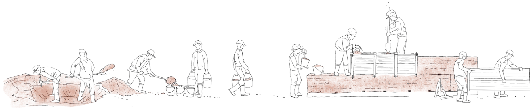
Figure 53 : réalisation d'un mur en pisé, crédit de l'auteur.
