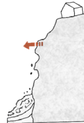
Eboulement de bancs rocheux
