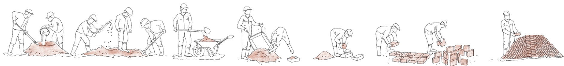
Figure 54 : réalisation d'un mur en adobe, crédit de l'auteur.
