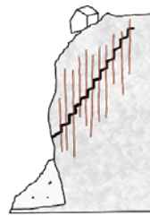
Rupture de surplomb
